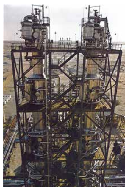
空气产品公司提供利比亚Sirte Oil Co.首个中型液化天然气工厂采用AP-SMR™工艺。
