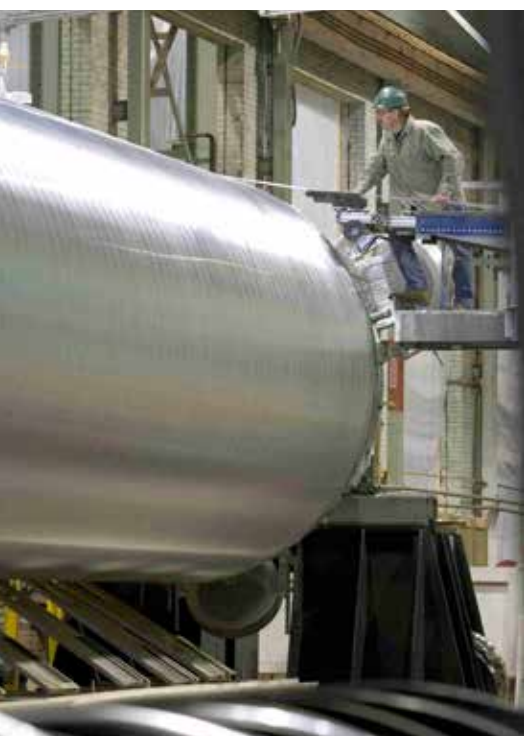
液化天然气换热器管束绕管过程
