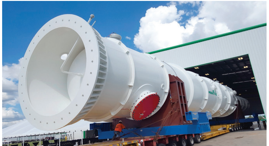
空气产品公司定制设计的大型绕管式换热器。
