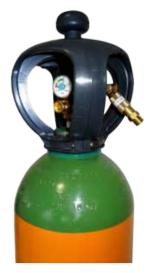
为200巴压力的Integra快易焊钢瓶特别设计。无需额外的气体减压阀,出口压力为4巴。只需要选定适合的气体流量优化装置,轻轻一转即可得到正确的气体流量。气体流量优化装置有不同的流量可供选择:分别为8,10,12,15,18,20和25升/分钟。
