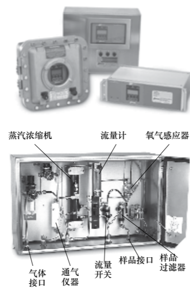
图7. 依靠氧气分析仪(上)和样品预处理系统(下)的浓度控制系统。样品预处理系统能确保分析仪在各种工艺条件(极端压力、真空和温度，高微粒含量和高湿度环境)下获得可靠的测量结果。图片由Neutronics Inc. 提供。
